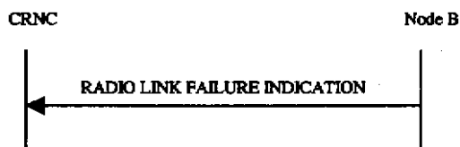
图 43 无线链路失败过程，成功的操作
