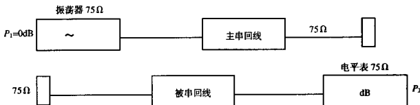
图4 75Ω/75Ω不平衡式连接器单元回线间远端串音防卫度测试原理
